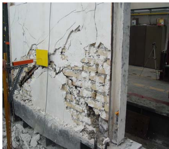
شکل ۸: نمایی بعد از آزمایش نمونه از طرف گچ کاری
