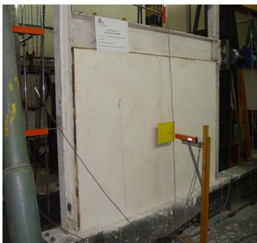
شکل ۷: نمایی از دیوار چینی داخل قاب قبل از نازک کاری
