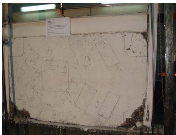
شکل ۱۱ نمایی از دیوار بهسازی شده بعد از آزمایش
