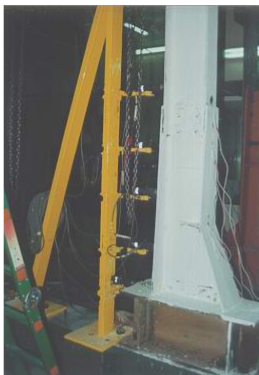
تصویر (۴): نمای چپ نمونه آزمایشی پس از دوغاب زدن
