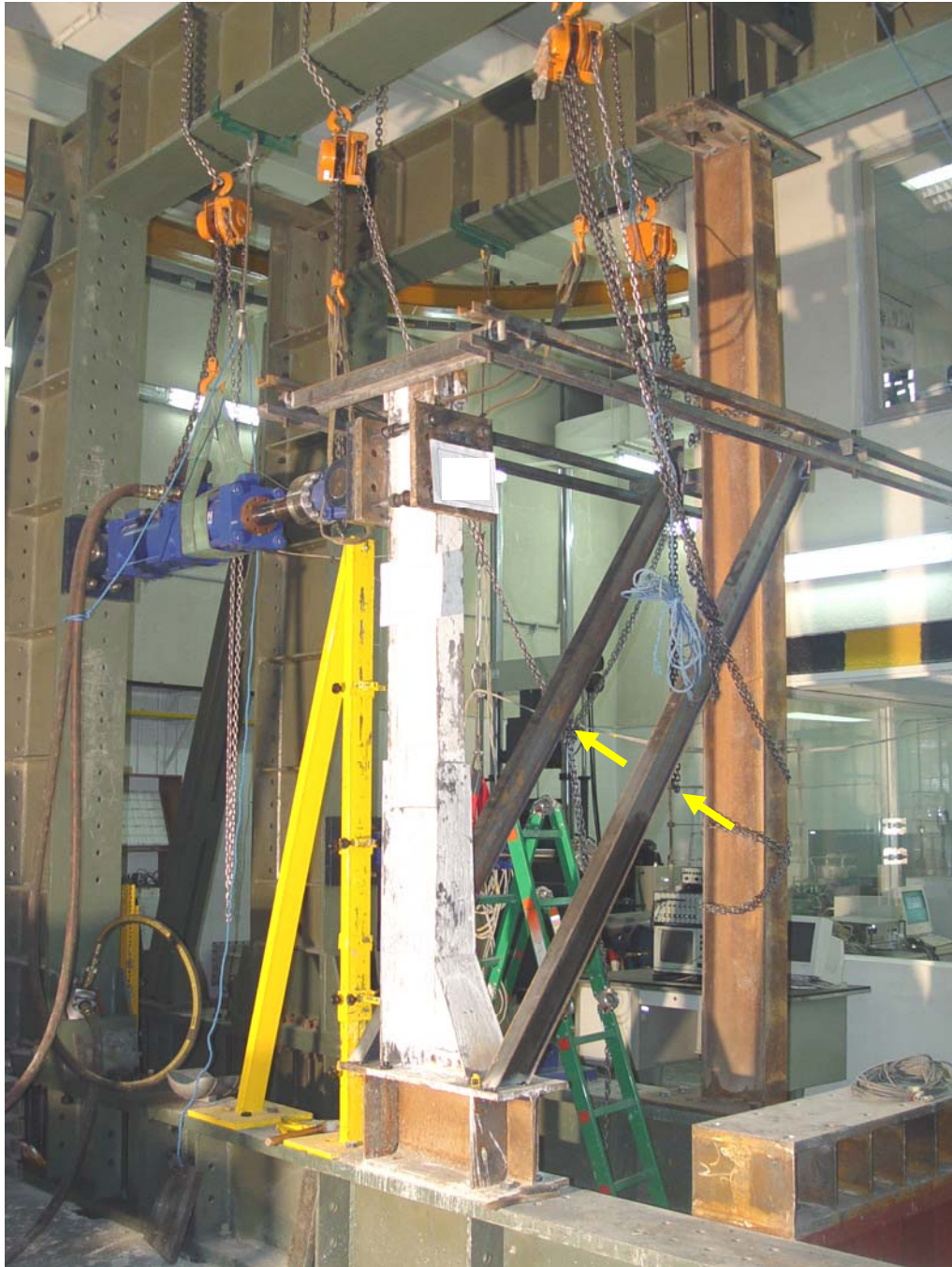
تصویر (۶): تأمین تکیه‌گاه جانبی با پانتوگراف فولادی
