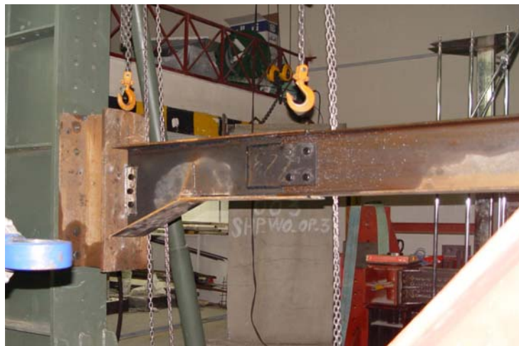
تصویر (۱): نمای کلی مونتاژ اتصال ستون IPB، نمونه اتصال و تیر میانی IPE
