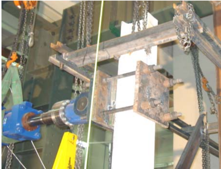
تصویر (۵): نحوه اتصال جک به نمونه
