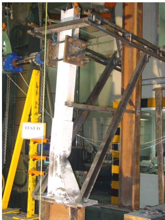
تصویر(۱۱): تغییر شکل بال زیرین. شکل گیری تورفتگی در بال در اثر کرنشهای پلاستیک ایجاد شده در این ناحیه ملاحظه می شود.
