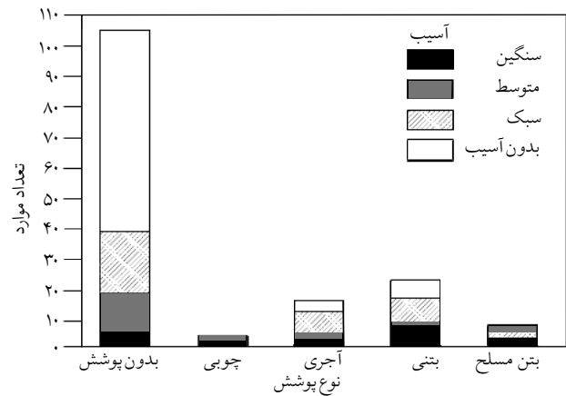
شکل (۹): تأثیر زلزله بر تونلها بر حسب نوع پوشش آنها [۸]
