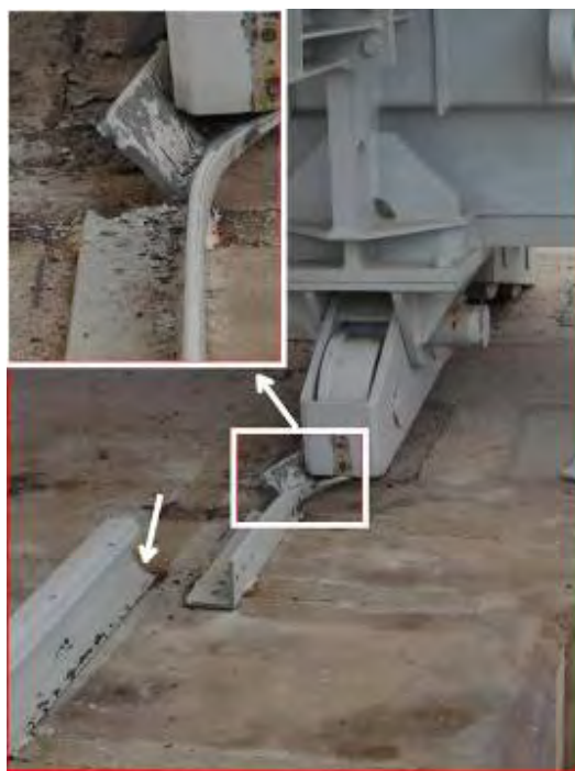
شکل (۶-۲۴): پاره شدن نبشی زیر سری
