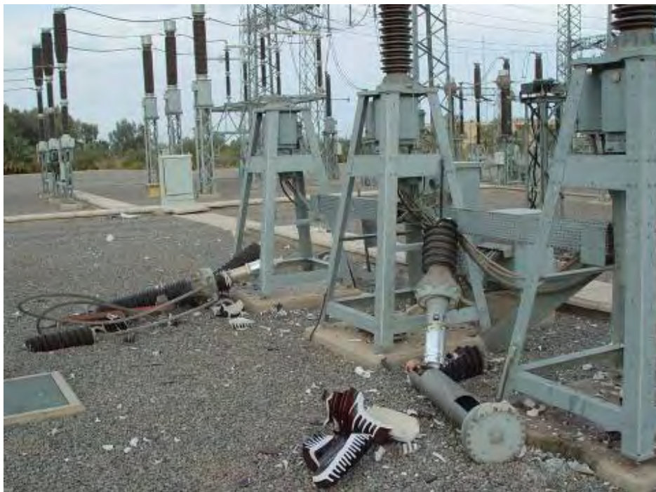
شکل (۶-۱۴): شکست مقره های از جنس چینی ترد شکن
