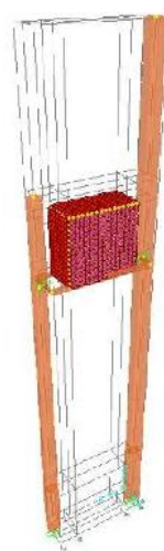
شکل ۹: مدل تحلیلی پست هوایی فاقد مهار سکوی ترانس
