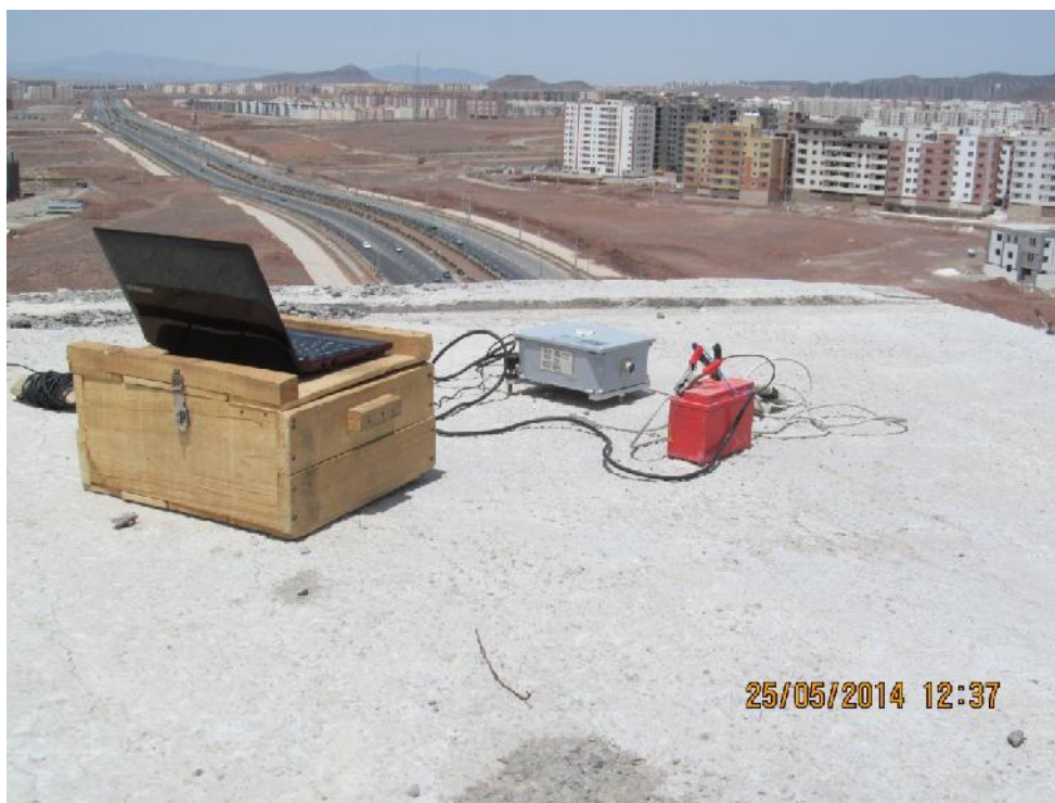
شکل ۱: نمایی از لرزه سنج بر بام سازه تونلی واقع در شهرک پرنده
