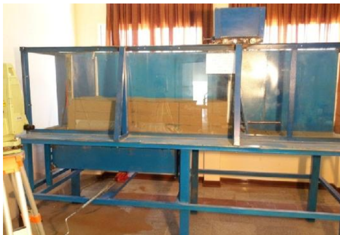
شکل ۳: نمای واقعی از دستگاه شبیه‌ساز گسلش معکوس
