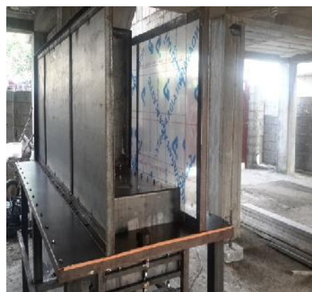
شکل ۱: تصاویری از مراحل اولیه ساخت دستگاه شبیه ساز گسلش معکوس
