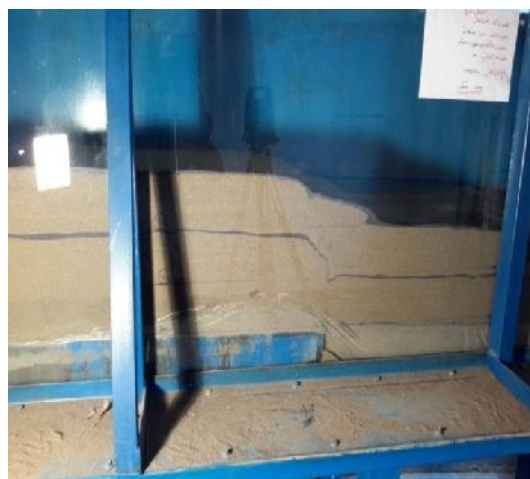
شکل ۷: اعمال جابجایی در قسمت متحرک مدل در آزمایش اول
