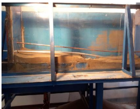
شکل ۱۰: تصویر تغییر شکل لوله‌ها پس از اعمال گسلش در آزمایش دوم
