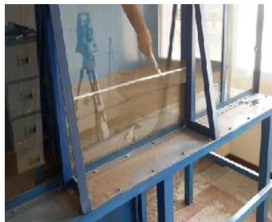
شکل ۵: ریختن لایه رنگی نشانگر در میان لایه‌ها
