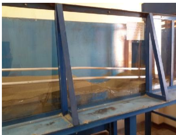
شکل ۱۲: تصویر تغییر شکل لوله‌ها پس از اعمال گسلش در آزمایش سوم
