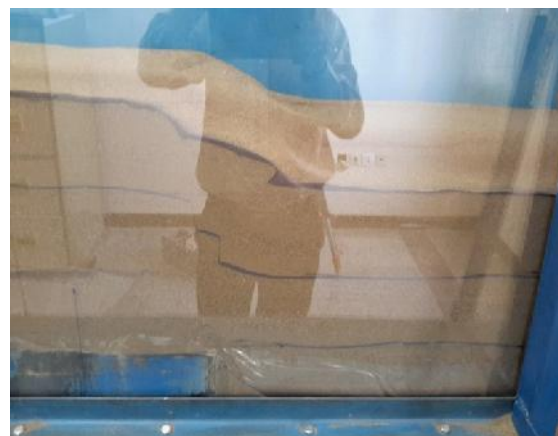
شکل ۱۱: اعمال جابجایی در قسمت متحرک مدل در آزمایش سوم
