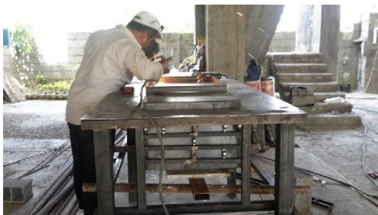
شکل ۱: تصاویری از مراحل اولیه ساخت دستگاه شبیه ساز گسلش معکوس
