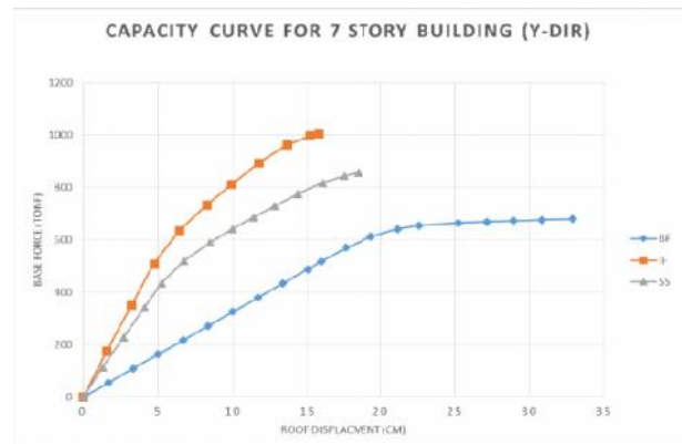
شکل ۲: منحنی ظرفیت ساختمان هفت طبقه در دو جهت X و Y
