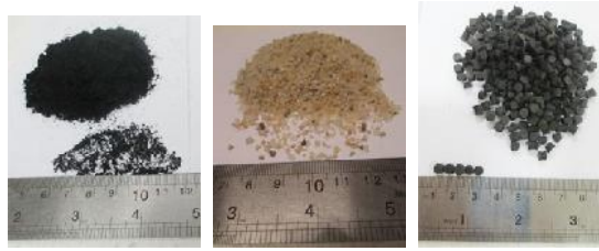
شکل ۲: از راست به چپ به ترتیب: گرانول لاستیک، ماسه و پودر لاستیک
