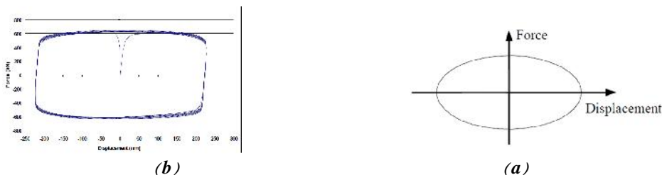
شکل ۱: (a) حلقه هیستریزیس میراگر با رفتار ویسکوز خالص (Shin. / (b) رفتار نیرو- تغییر مکان میراگر ویسکوز (Baldo et al., hysteresis loop)
