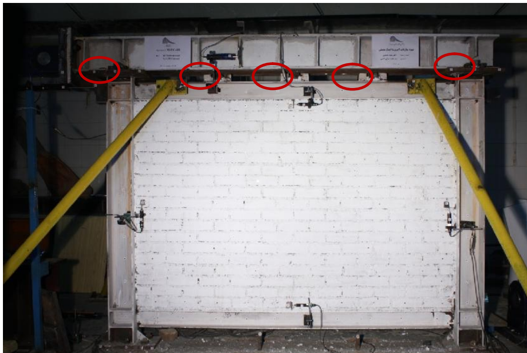
شکل ۳: شکل کلی نمونه آزمایشگاهی قبل از شروع تست به همراه تیر بارگذاری و کلیدهای برشی برای انتقال نیروی جانبی از جک به نمونه که در بیضی‌های توپر نشان داده شده است.
