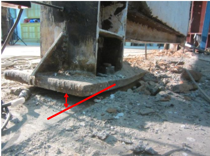
شکل ۶: بلندشدگی ورق کف ستون در جابجایی نسبی ۷/۴ درصد
