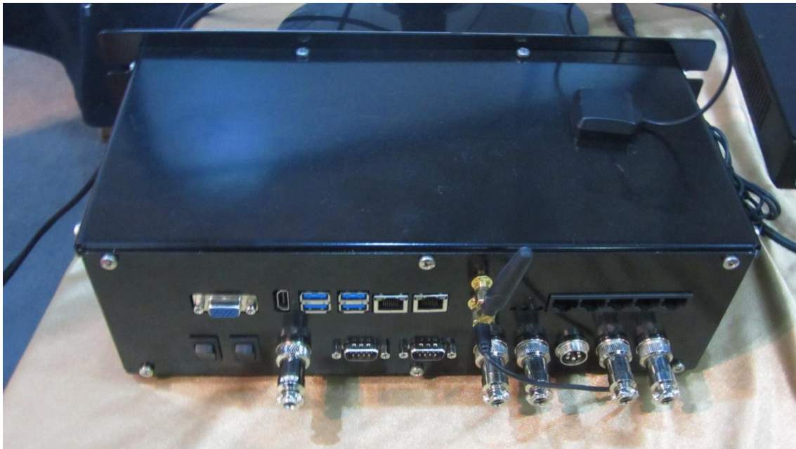
شکل ۲: RTU طراحی شده برای سامانه قطع جریان گاز زلزله
