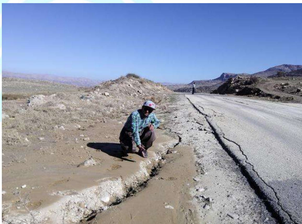
شکل ۱۰-۱۴- آسیب دیدن بدنه راه بر اثر روانگرایی در محور تازه‌آباد-سرپل‌ذهاب
