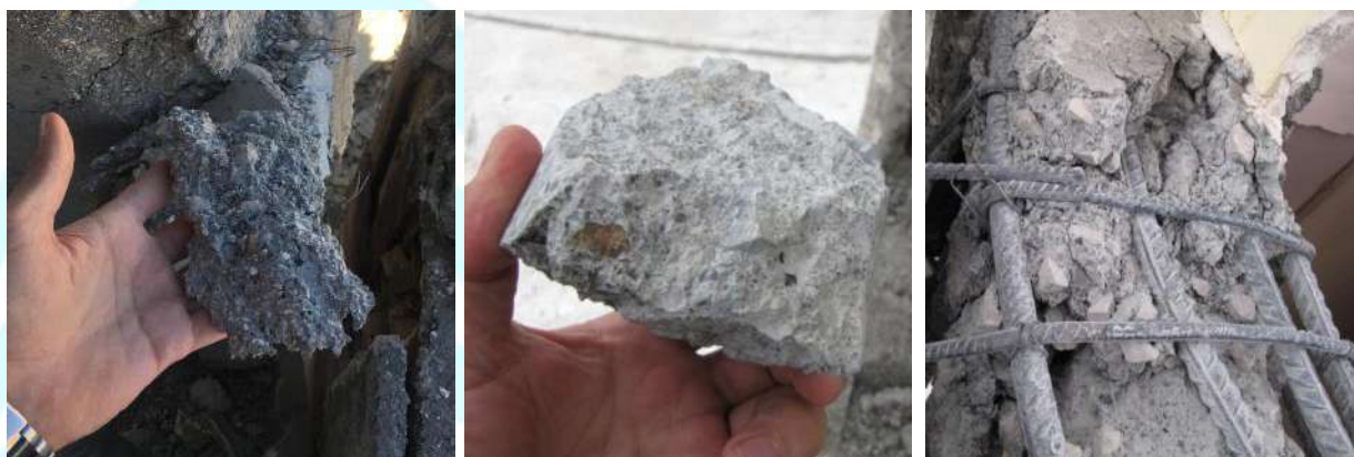
شکل ۵-۹- نمایی از بتن‌های فاقد شن یا سنگدانه‌های گسسته
