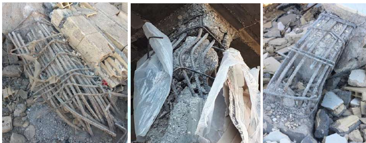
شکل ۵-۲۱- عدم رعایت ضوابط میلگرد گذاری
