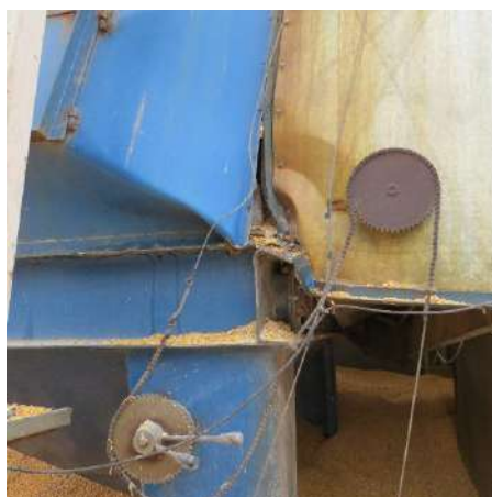
شکل ۱۱-۲۱- رفتار پلاستیک در پایه دستگاه ذرت خشک‌کنی ساخت شرکت عمران صنعت متعلق به شرکت ذرت خشک‌کنی
