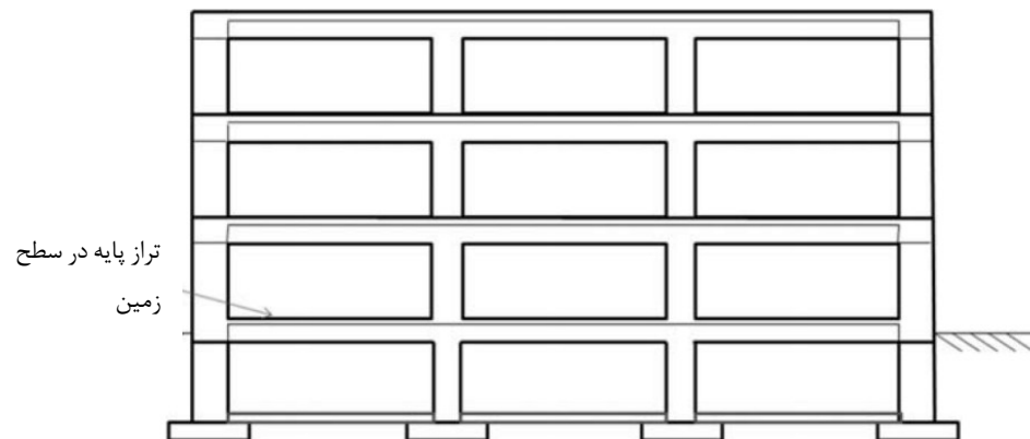
شکل ت-۴-۱۷: ساختمان دارای زیرزمین
